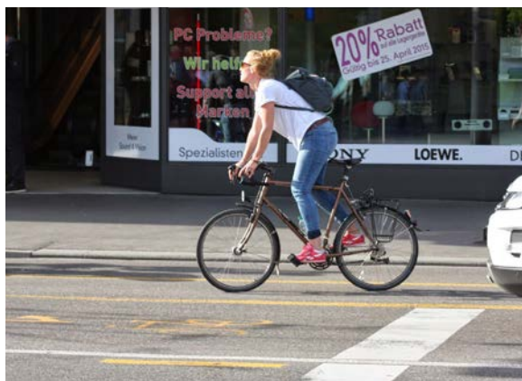
Illustration 24. Sas vélo permettant aux cycles de repartir en premier quand le feu passe au vert (photo : Aline Renard).
